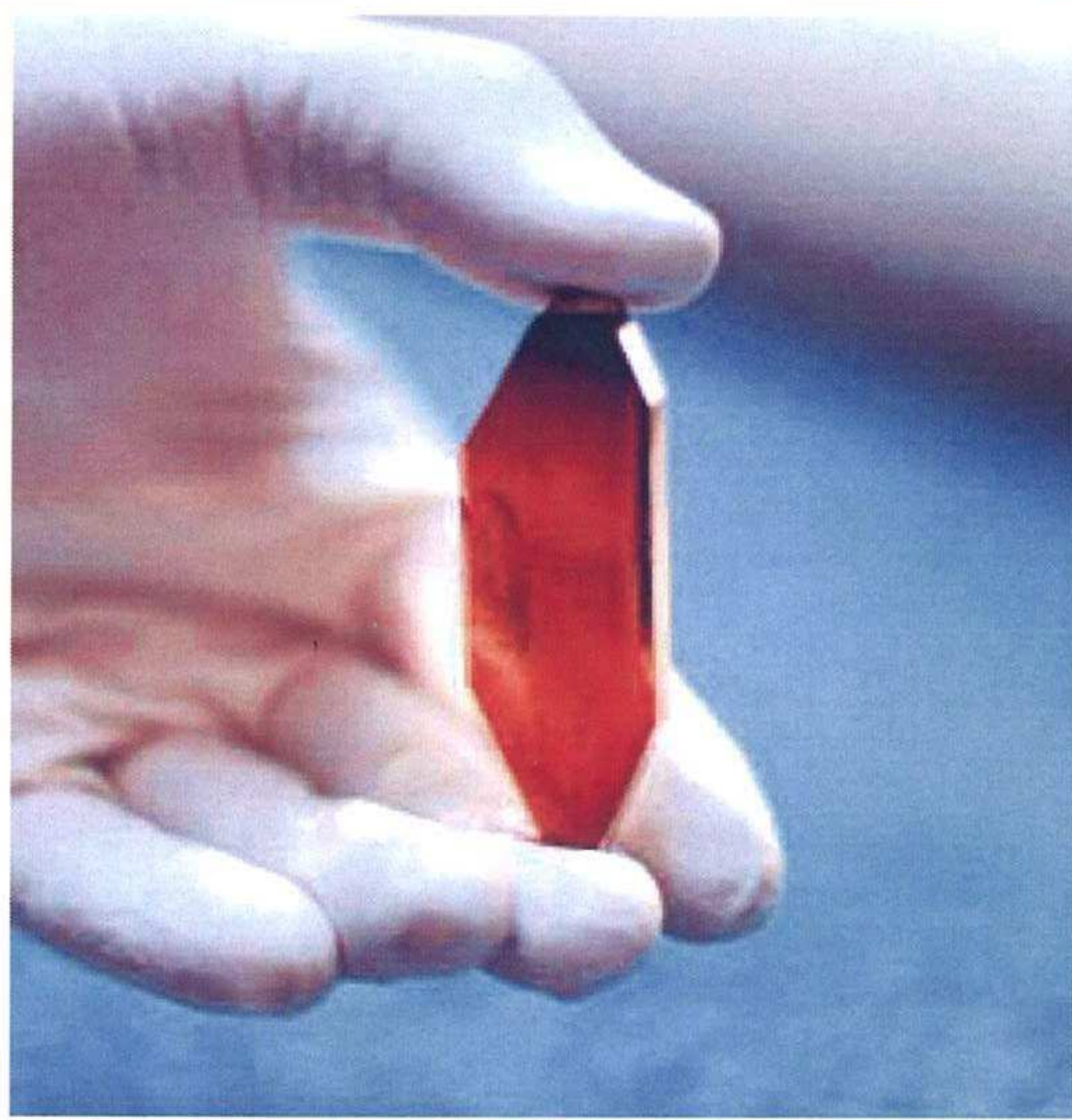
Ammono ma własny patent na najlepsze na świecie kryształy azotku galu. Rodzą się w autoklawach, w temperaturze 400-500 st. C i pod ciśnieniem do 5000 atmosfer
